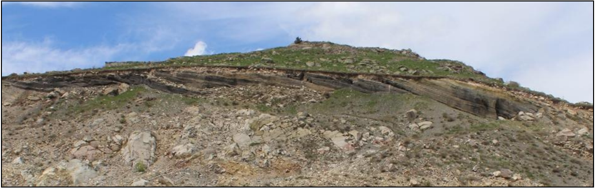
Foto 1. Taşhane Tepe'nin Güney Yamaçlarında Piroklastik Unsurlardan Oluşan ve Hafriyat Alınması Sonucu Açığa Çıkan Tabakalı Göl Depoları (Tabakalardaki eğim yönü doğuya doğrudur).
