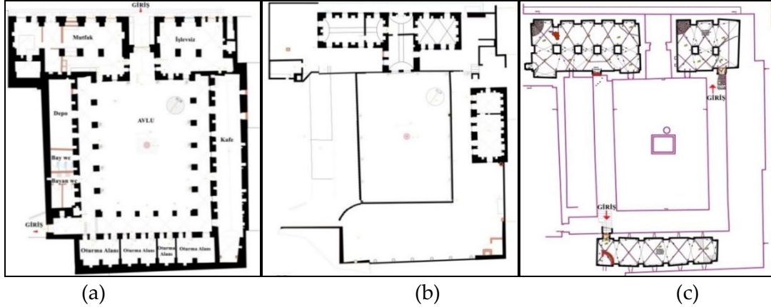
Şekil 5: (a) Zemin Kat Planı, (b) Birinci Kat Planı, (c) Bodrum Kat Planı (Güler, 2023, düzenlenerek)
